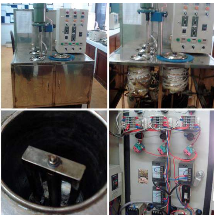
Hình 3. Hệ thống thiết bị phối trộn nhũ tương nhựa đường
