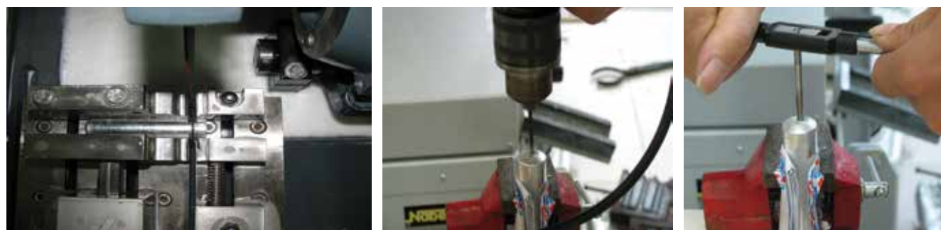
Hình 4. Mô tả quá trình gia công mẫu thử nghiệm
